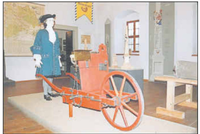
Funktionstüchtiger Nachbau einer zur Straßenvermessung genutzten Messkarre im Osterzgebirgsmuseum Schloss Lauenstein Diese Datei ist unter der Creative Commons Attribution-Share Alike 3.0 Unported Lizenz lizenziert.
