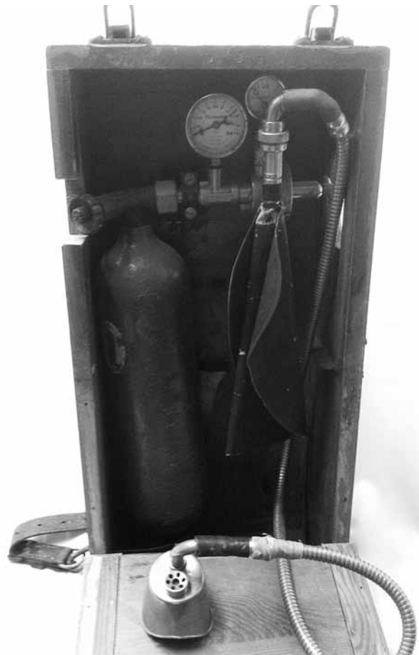
Tornistersauerstoffgerät der Firma Dräger von 1914.
